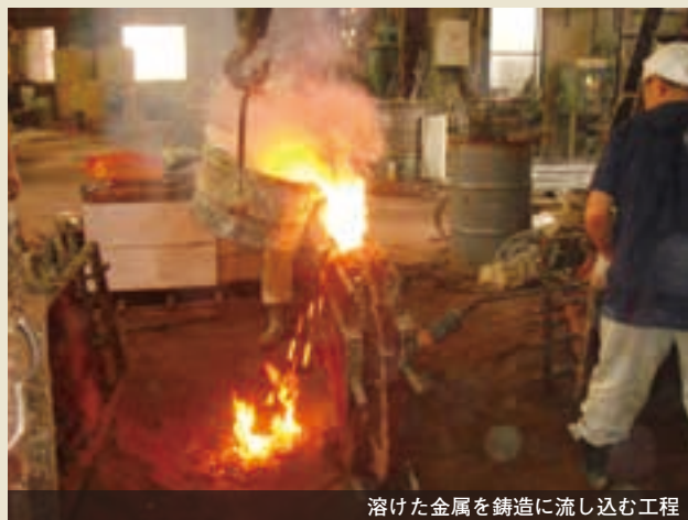
溶けた金属を鑄造に流し込む工程
